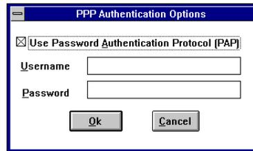
Il campo Use P.A.P. specifica che login e password sono da inserire nei due campi sottostanti.
